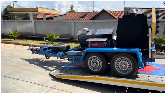
ภาพที่ 6 ชุดอุปกรณ์เครื่องตรวจสอบฯ จะติดตั้งไว้บนเทรลเลอร์ลากจูงขนาด 4 ล้อ
