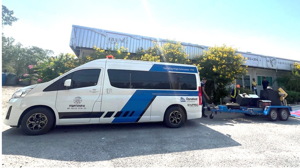
ภาพที่ 4 เครื่องตรวจสอบความแข็งแรงโครงสร้างชั้นทางแบบต๋มน้ำหนักระแทก Fast Falling Weight Deflectometer รุ่น Dynatest 8012
